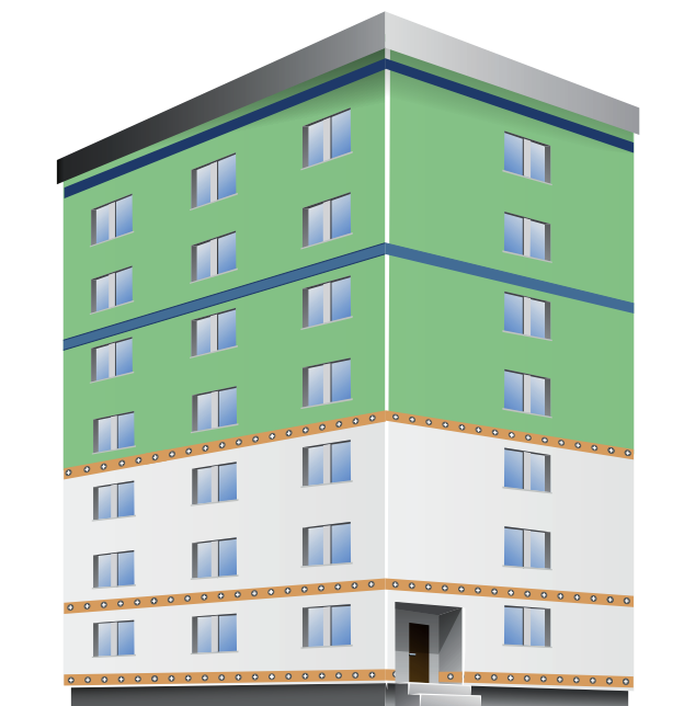
Brandriegel verhindern den Brandüberschlag über die Fassade.
